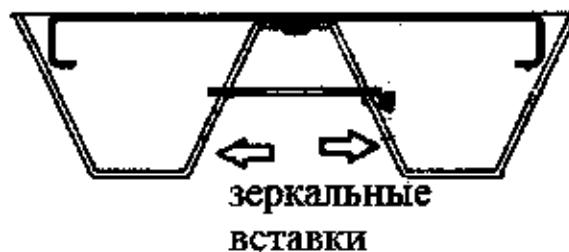
Рисунок 1 – Конструкция светильника
