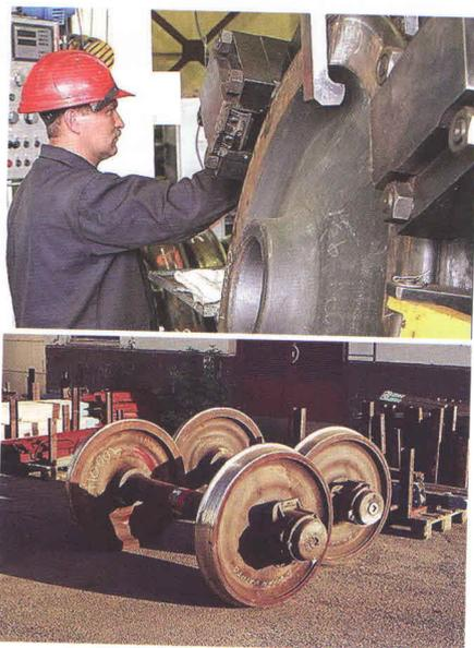
емой колесной пары и ее плавное вращение с заданной для сварочных полуавтоматов скоростью. В качестве электрода используется сварочная проволока диаметром от 1 до 6 мм. Подача проволоки (100–300 м/час) регулируется с помощью специального устройства. Флюс к месту наплавки подается по шлангу сжатым воздухом давлением 0,5–1,0 атм., которое регулируется редуктором, установленным перед входом в маслобак.
