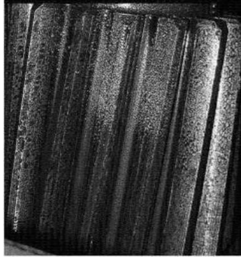
Рис. 1 – Состояние зубчатого колеса редуктора, до обработки ТС НИОД
