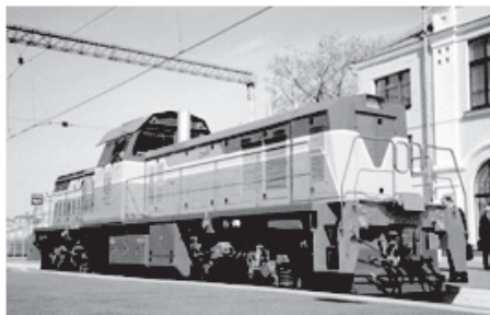
Рис. 1. Маневровый тепловоз ТЭМ9Н SinaraHybrid с гибридной силовой установкой
